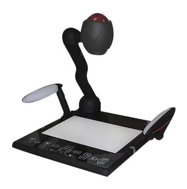
Cámara Display SXGA con resolución de 1280x1024 Zoom Óptico de 12x y Zoom digital de 8x Rotación horizontal y vertical de 350° Luz LED para optimo control de iluminación
